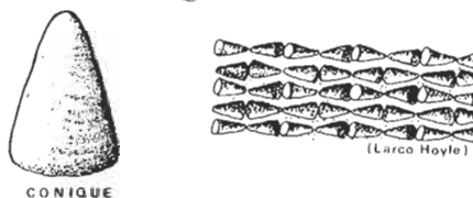
FIGURE 147 : DIFFÉRENTES FORMES DE BRIQUES NON PARALLÉLEPIPÉDIQUES
