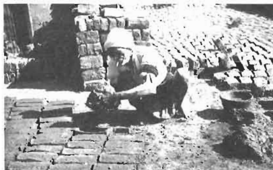
▲ FIGURE 156 : LA BOULE EST MOUILLÉE AVANT D'ÊTRE JETÉE DANS LE MOULE
