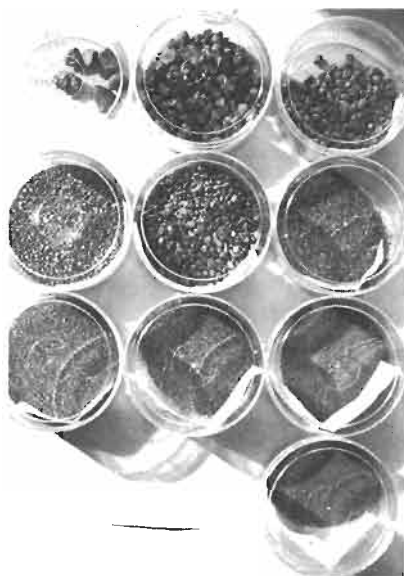
FIGURE 245 : DECOMPOSITION D'UNE TERRE LATERIQUE APRES GRANULOMETRIE
