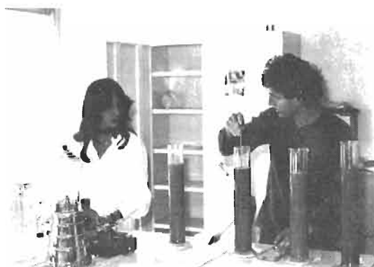
FIGURE 247 : SEDIMENTOMETRIE, MESURE EN LABORATOIRE
