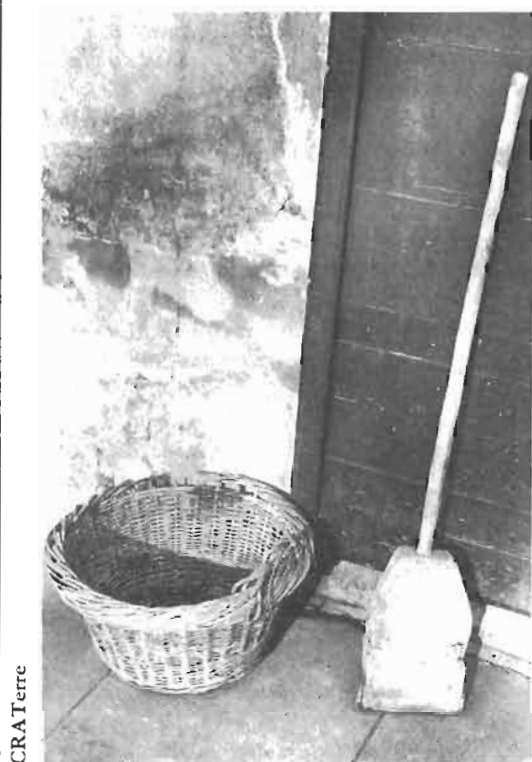
FIGURE 52 : CORBEILLE ET PISOIR UTILISÉ TRADITIONNELLEMENT
